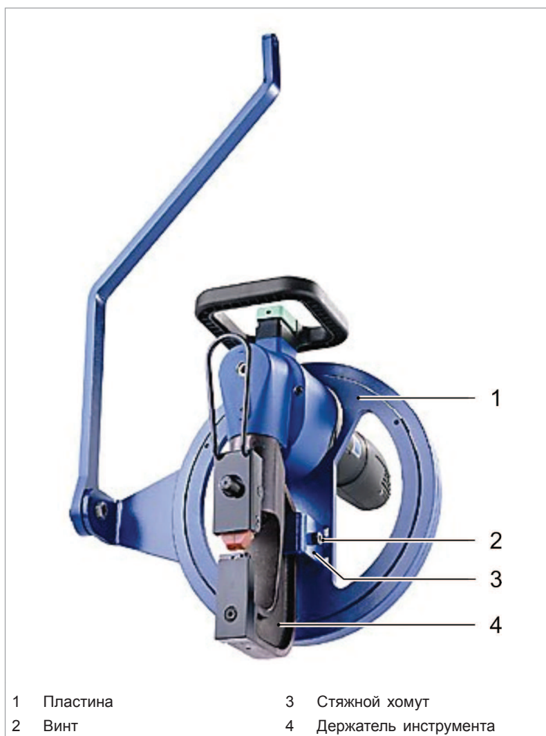
TruTool TF 350 с монтированным поворотным венцом
