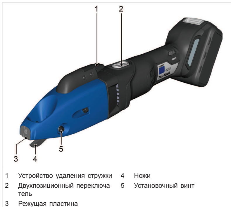
Шлицевые ножницы TruTool C 250
