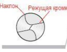
Если внимательно рассмотреть хорошо заточенное сверло, то видно, что поверхность от режущей кромки вниз по наклону до самой нижней точки хорошо шлифованная без углублений и других изъянов. И режущая кромка всегда выше нижней точки наклона.
