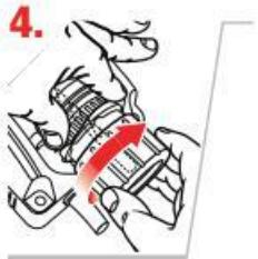
Затяните патрон, повернув его ручку по часовой стрелке. Зажав сверло, позвольте ему, тем не менее, немного скользить в патроне взад-вперед. Патрон не должен быть полностью затянут, до тех пор, пока мы точно не установим величину выступания сверла из патрона на следующем этапе. Вращайте сверло в патроне, чтобы передняя кромка канавки сверла оказалась напротив зажима (пластины для выравнивания). Это необходимо, чтобы выровнять сверло для правильной заточки.
